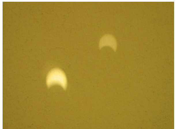
Illustration 18: Image fournie par un sténopé à miroir (2 trous).
